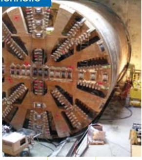
Le tunnelier construit pour creuser sous le Rhône mesurera près de 10 mètres de diamètre. Cette spectaculaire machine est capable de percer les terrains les plus résistants. La technique repose sur l'action de la roue de coupe située à l'avant, combinée à la poussée d'immenses vérins.
